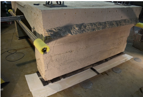
Figura 10. Apoyo de neopreno sobre teflón bajo una de las almas.
